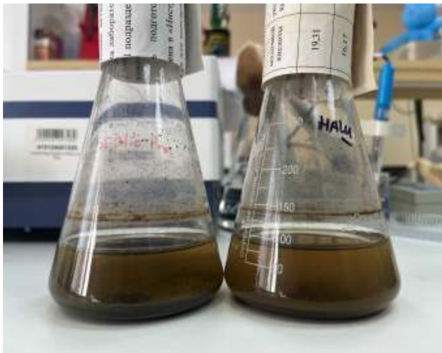
Рисунок 7 – Колбы с ОСВ и препаратами через 10 суток Слева направо – «SepticPro», наш «Утилизатор»
