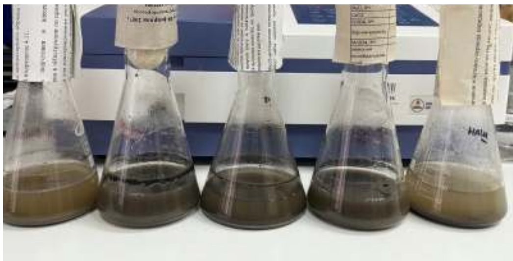
Рисунок 5 – Колбы с ОСВ и препаратами через 4 суток Слева направо – «SepticPro», «Зеленый пакет», «Ехрел», «Доктор Робик», наш «Утилизатор»
