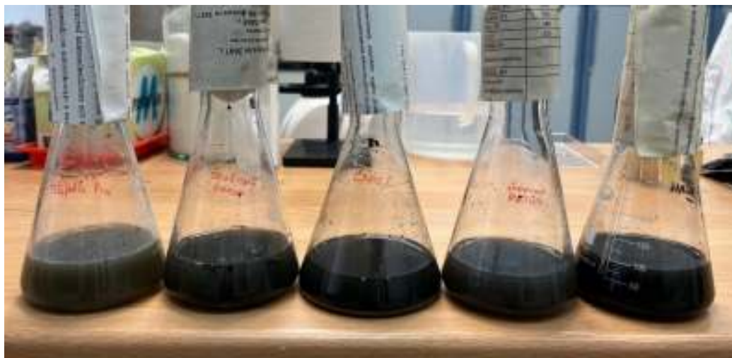
Рисунок 4 – Колбы с ОСВ и препаратами на начала опыта Слева направо – «SepticPro», «Зеленый пакет», «Ехрел», «Доктор Робик», наш «Утилизатор»
