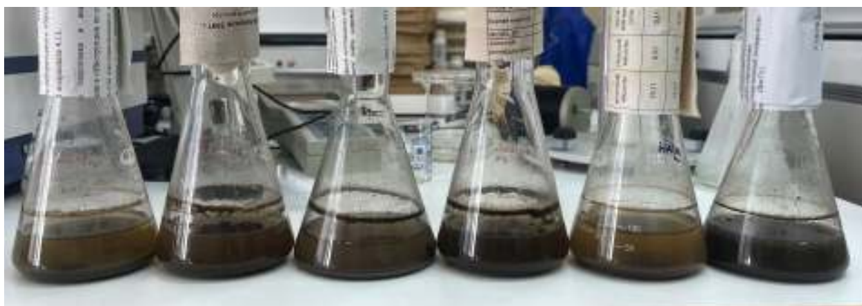
Рисунок 6 – Колбы с ОСВ и препаратами через 10 суток Слева направо – «SepticPro», «Зеленый пакет», «Ехрел», «Доктор Робик», наш «Утилизатор», контрольная колба без препарата
